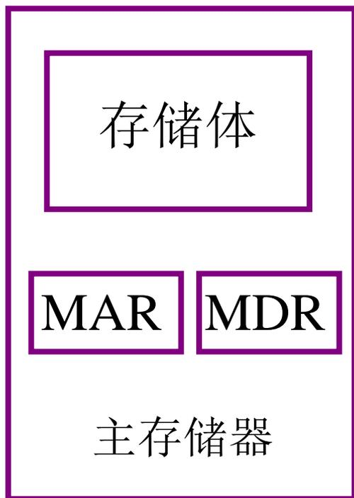
存储体 – 存储单元 – 存储元件 (0/1)
